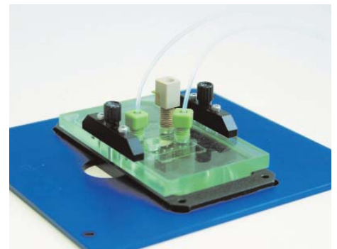
Abb. 3: Mikroskopierzelle als Basis für einen Nanoassembler (Bild: GeSiM mbH Rossendorf)
